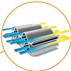
Détail d'une roue dessicante Seibu Giken. La multitude des canaux d'air permet d'extraire l'humidité avec une réelle efficacité.
